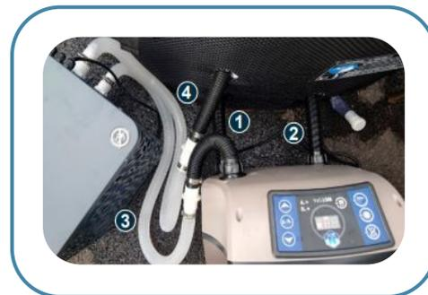
1. Raccordez le tuyau d'air au blower.
