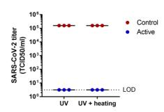
L'échantillon a été placé face contaminée vers le haut, directement sous les LED UV au centre de l'appareil. Les cycles de désinfection 1 (UV) et 2 (UV+chaleur) ont été testé. Dans ces conditions de test, nous avons calculé un abattement d'au moins 4log10 pour le SRAS-CoV-2 (graphique à droite). L'efficacité en fonction de la position de l'échantillon, de la face contaminée et de la présence d'encombrement dans l'appareil n'ont pas été testé.
